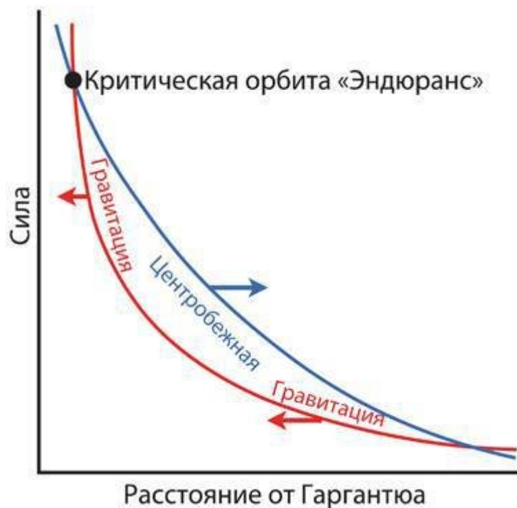
Рис. 27.6. Гравитационная и центробежная силы, действующие на «Эндюранс», и их изменение в зависимости от расстояния до Гаргантюа
