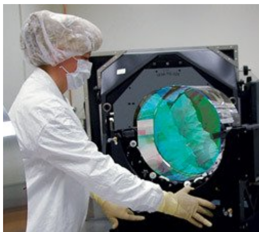
Рис. 26.2. 40-килограммовое зеркало, подготовленное для установки в ЛИГО. Его положение квантовомеханически флуктуирует — очень-очень слабо, на одну десятиллиардную от диаметра атома
